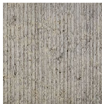
Zpevněné plochy cest škrábaný beton
