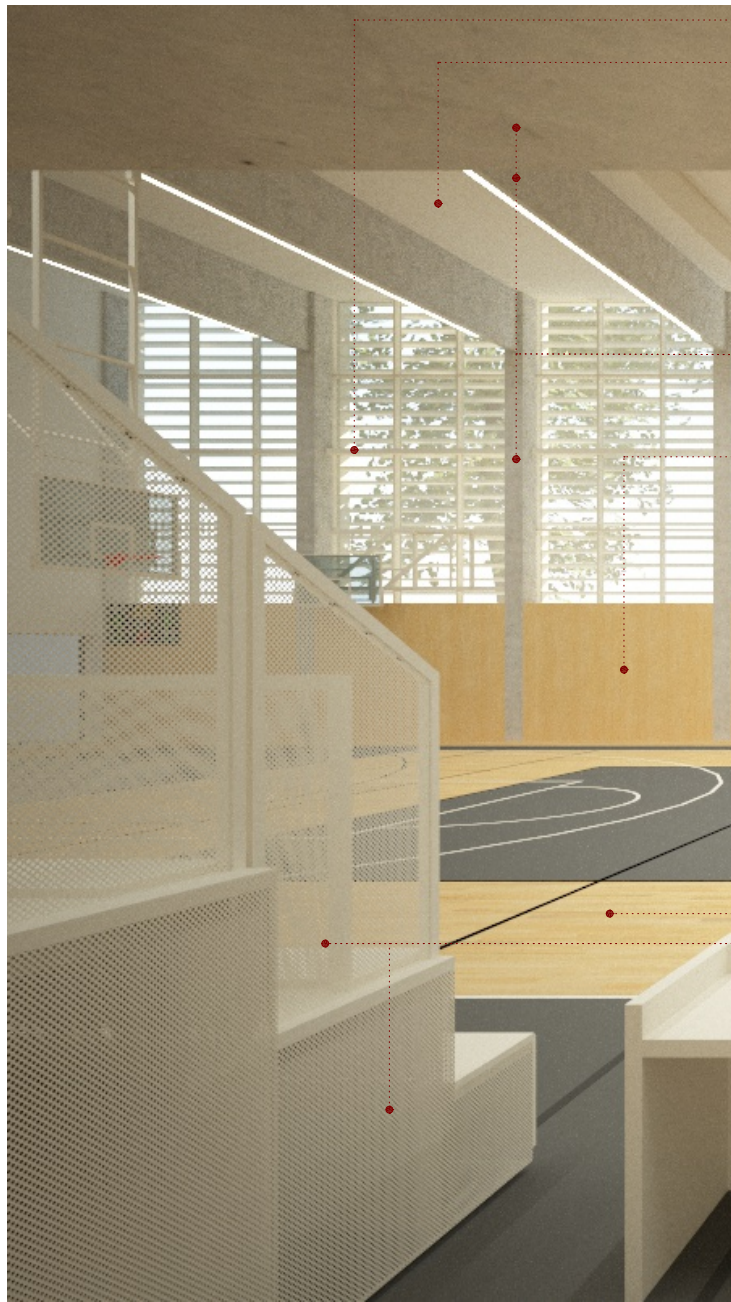
DŘEVĚNÝ OCHRANNÝ OBKLAD březové překližky tl.15mm 1500/3000mm na dřevěném roštu součástí obkladu zapuštěné parapety a vyřezové otvory pro vytápění povrchá úprava bezbarvá, ochranná dle podmínek PBR JUNCKERS
