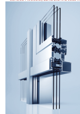
SLOUPKO-PAŽDÍKOVÁ FASÁDA hliníková předsazená okenní fasáda Jednotné sloupky a paždíkы, trojsklo, přítlačné lišty součástí otevírává okna a plně kazety pro prostupy VZT SCHUCO FWS.50.SI, barva bílá RAL 9010 mat
