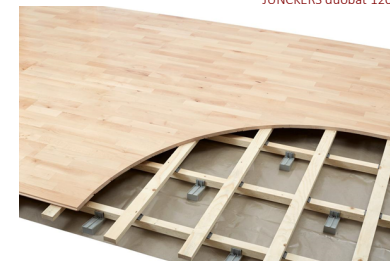
SPORTOVNÍ ROŠTOVÁ PODLAHA masivní palubková podlaha na dřevěném roštu jasanové palubky 22/129mm, matný bezbarvý lak JUNCKERS duobal 120+
