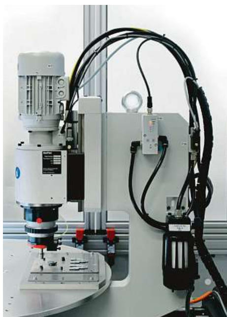
Automatická nýtovací stanice RNC 231 byla vyvinuta tak, aby umožňovala až ztrojnásobit rychlost výrobního procesu i v provozech malé a střední velikosti.
